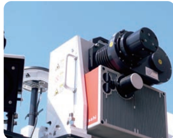
MMS-Gはより高精度な点群データの収集が可能
