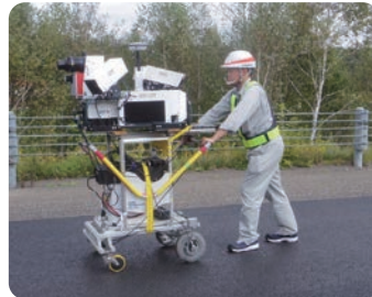
通常車両の通行が困難なため、MMSを手押し台車に搭載して計測
