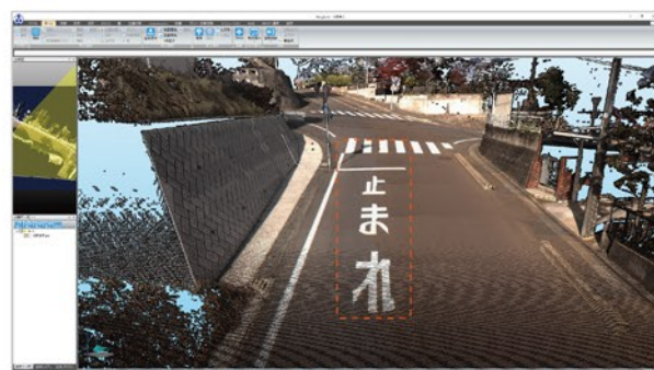
XY 変換によって正常な 止まれ に
