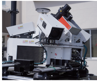
MMS-Gはより高密度な点群データの収集が可能
