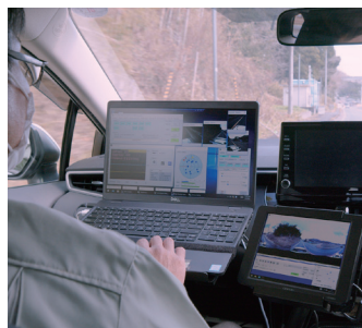
点群データ取得と同時に写真撮影もできるため、道路台帳の更新にも有効。
